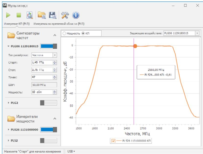
Multitest – программное обеспечение, позволяющее объединить управление несколькими устройствами в одном приложении. Программа Multitest создана специально для решения типовых измерительных задач и включает в себя режимы, расширяющие возможности портативных приборов серии PLD.
